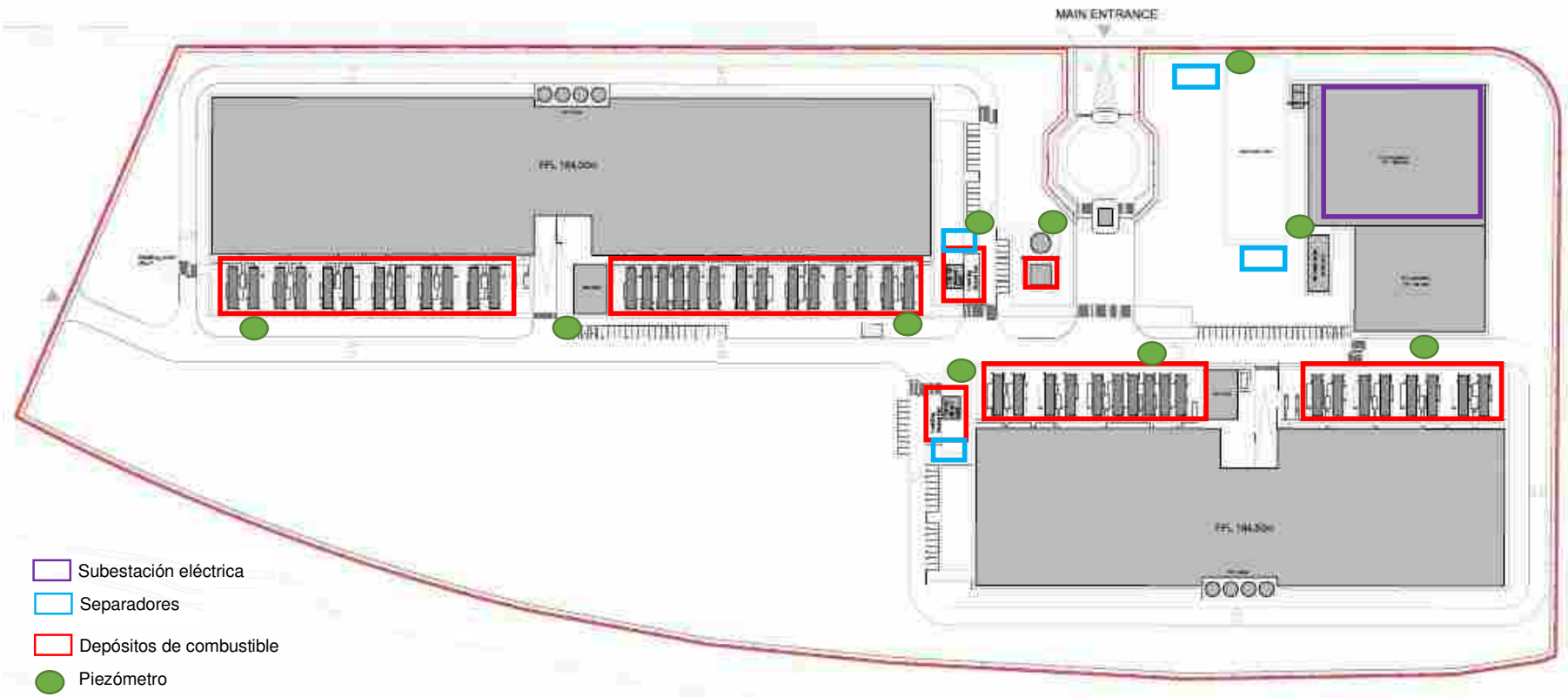
Figura 12.3 Propuesta de red piezométrica de control
