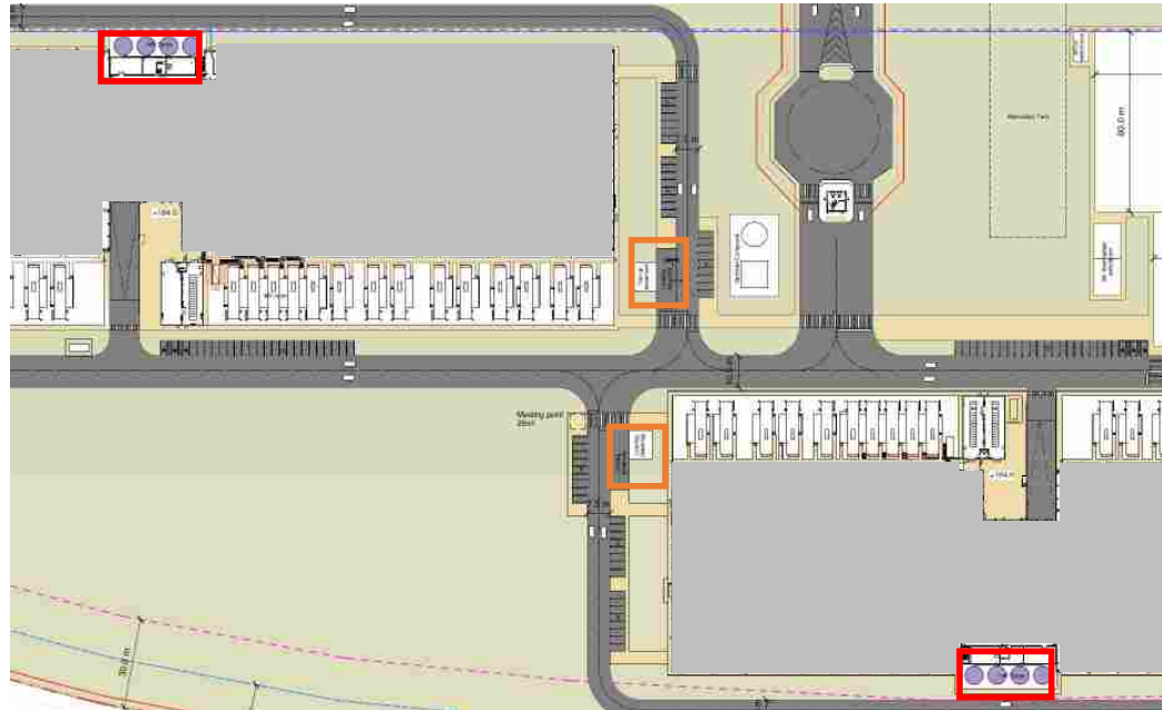
Figura 4.9 Ubicación de las plantas de tratamiento de agua y de los depósitos de almacenamiento (en rojo). Los top up tanks de diésel (en naranja)
