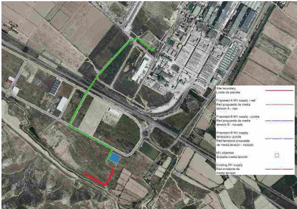
Figura 4.10 Ubicación de los principales elementos para el abastecimiento de energía eléctrica Línea de Alimentación de 10MW–Fase 2 (en verde) y Línea de Alimentación de 30MW–Fase 3 (en rojo)
