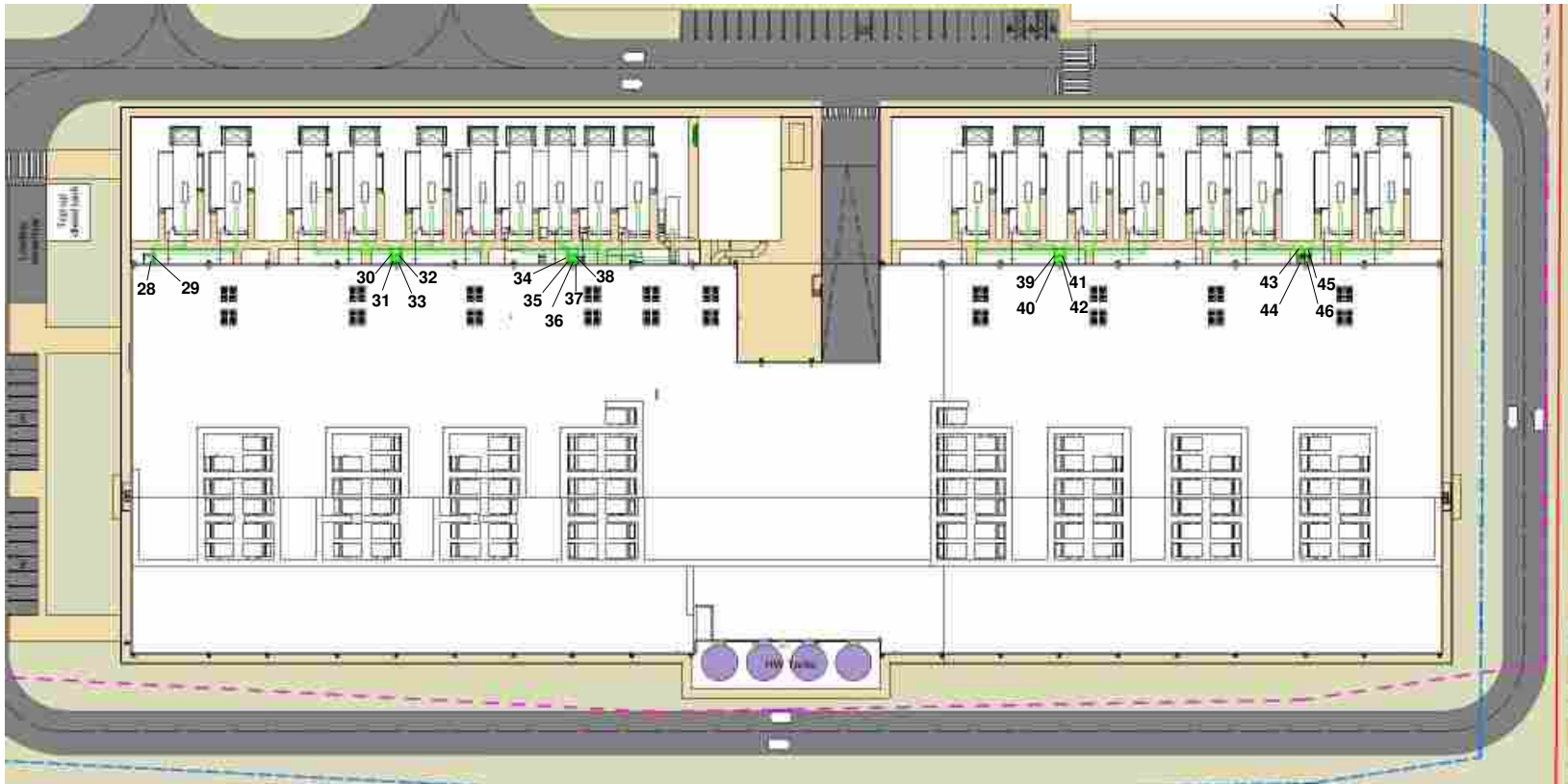
Figura 8.7 Localización de los focos de emisión a la atmósfera (edificio B)
